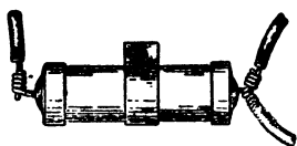
Фиг. 8-10. Использование вывода конденсатора КБГМ в качестве опорной точки.
